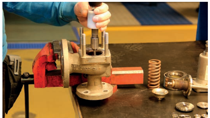
Slipning av säkerhetsventil.
